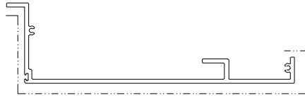
模號: X86607 名稱: 露台底 合金狀態: 6063-T6 重量: 2.777 KG/M V.F.: 418.1 mm
