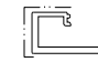
模號: X86593 名稱: 企內裝玻璃槽 合金狀態: 6063-T6 重量: 0.557 KG/M V.F.: 93.7 mm
