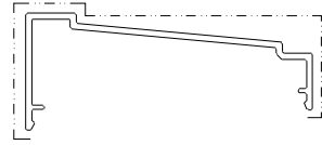
模號: X86585 名稱: 頂山 合金狀態: 6063-T6 重量: 1.954KG/M V.F.: 293.0 mm
