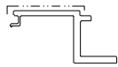
模號: X86602 名稱: 底橫冷氣位□ 合金狀態: 6063-T6 重量: 0.971 KG/M V.F.: 133.1 mm
