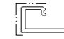
模號: X86593 名稱: 企內裝玻璃槽 合金狀態: 6063-T6 重量: 0.557KG/M V.F.: 93.7 mm
