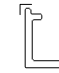
模號: X86588 名稱: 底橫室內裝飾托角 合金狀態: 6063-T6 重量: 0.606KG/M V.F.: 73.1 mm
