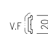
模號: X86575 名稱: 歐標槽拉巴 合金狀態: 6063-T5 重量: 0.128KG/M V.F.: 30 mm
