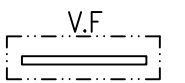
模號: BT4064 名稱: 21X3鋁巴 合金狀態: 6063-T6 重量: 0.185KG/M V.F.: 48 mm
