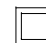
模號: JM3094 名稱: 20X20X2.5鋁通 合金狀態: 6063-T6 重量: 0.512 KG/M V.F.: 0 mm
