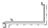
模號: X86433 名稱: 趟門頂外蓋 合金狀態: 6063-T5 重量: 0.688KG/M V.F.: 160.51mm
