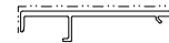
模號: X86447 名稱: 趟門玉企外蓋 合金狀態: 6063-T5 重量: 0.608KG/M V.F.: 121.97mm
