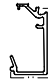
模號: X86439 名稱: 趟門框頂玻璃線 合金狀態: 6063-T5 重量: 0.365KG/M V.F.: 102.3 mm
