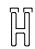
模號: X86437 名稱: 趟門底路軌 合金狀態: 6063-T6 重量: 0.273KG/M V.F.: 50.09 mm
