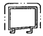
模號: X86200 名稱: 50生窗玻璃綫 合金狀態: 6063-T5 重量: 0.276 KG/M V. F.: 41.3 mm
