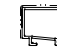
模號: X86109 名稱: 50生窗玻璃綫 合金狀態: 6063-T5 重量: 0.268 KG/M V.F.: 60 mm
