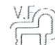
模號: X86325 名稱: 趟門路軌 合金狀態: 6063-T5 重量: 0.183 KG/M V.F.: 32.4 mm
