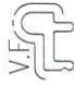
模號: X86325 名稱: 趟門路軌 合金狀態: 6063-T5 重量: 0.183 KG/M V.F.: 32.4 mm
