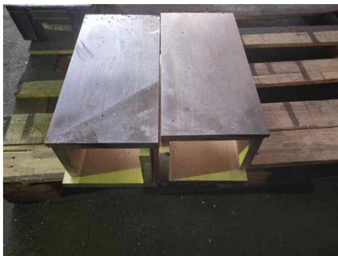
缺陷鉻化料表面塗瀝清油后的效果
