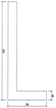
模號: X86266 名稱: 铝码 合金狀態: 6061-T6 重量: 9.12 KG/M V.F.: -
