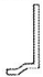
模號: X845451 名稱: 反拍線擋膠鋁角 合金狀態: 6063-T5 重量: 0.077KG/M V.F.: 0 mm
