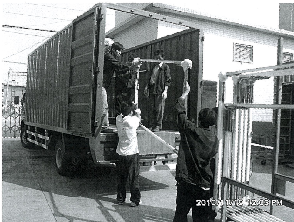
進行鋁窗保護措施的測試效果——以檢測多次搬運後，鋁窗夾口防漏水的效果
