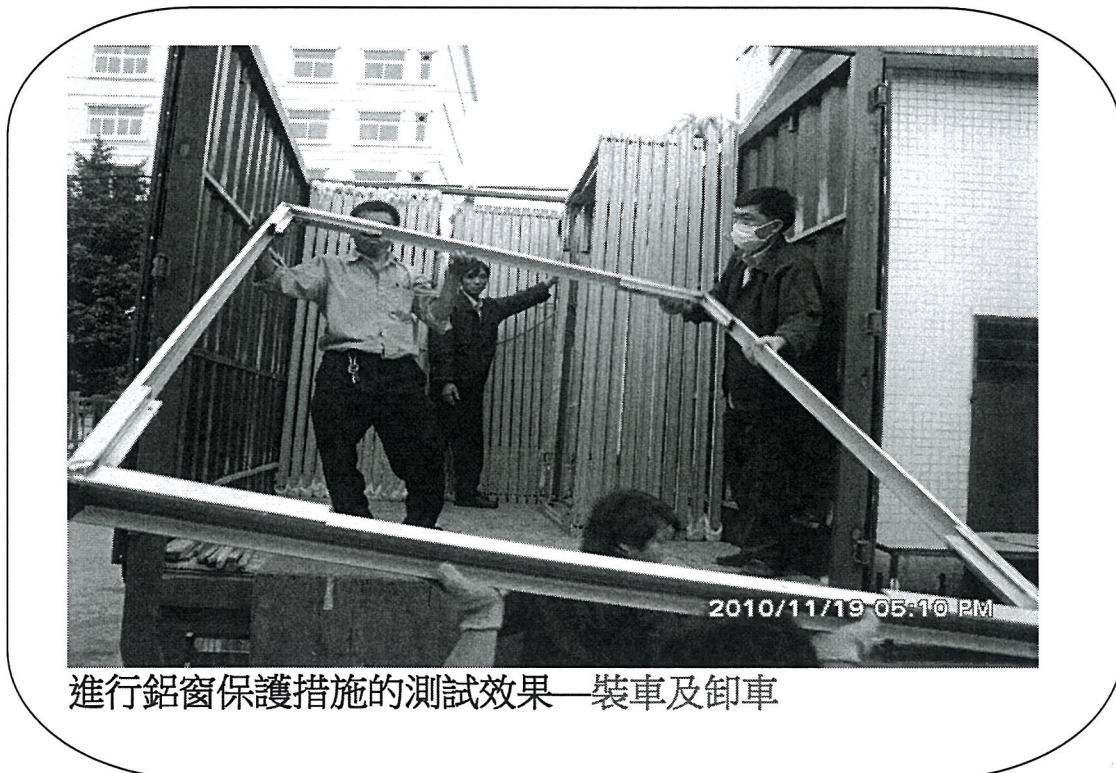
進行鋁窗保護措施的測試效果——以檢測多次搬運後，鋁窗夾口防漏水的效果
