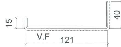
模號: X85671 名稱: 室內SD橫向收口 合金狀態: 6063-T5 重量: 0.925KG/M V.F.: 174.20mm
